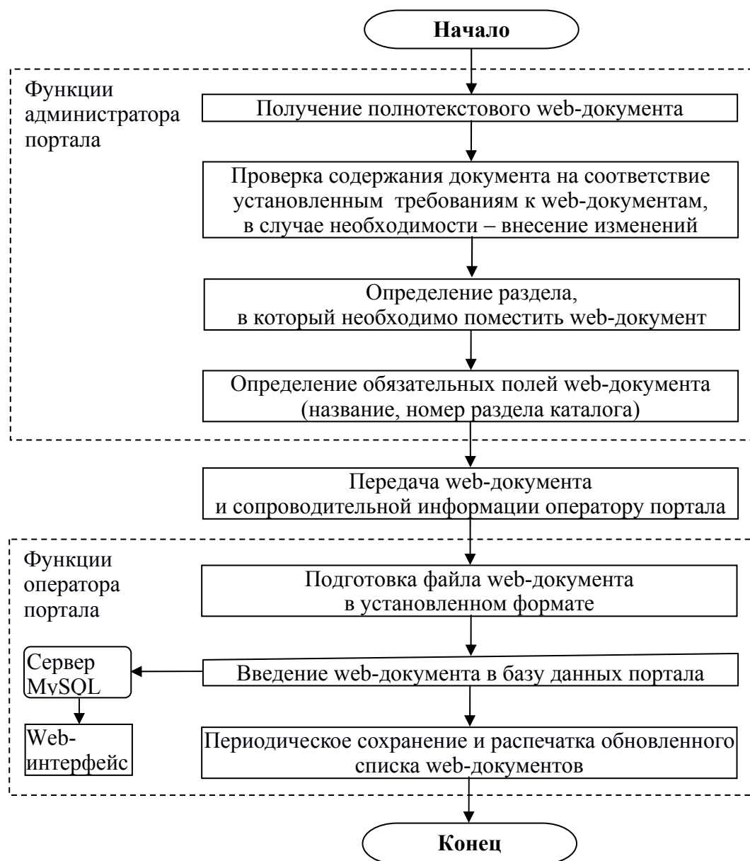
Рис. 1. Схема взаимодействия с документами, вводимыми в базу данных образовательного портала
