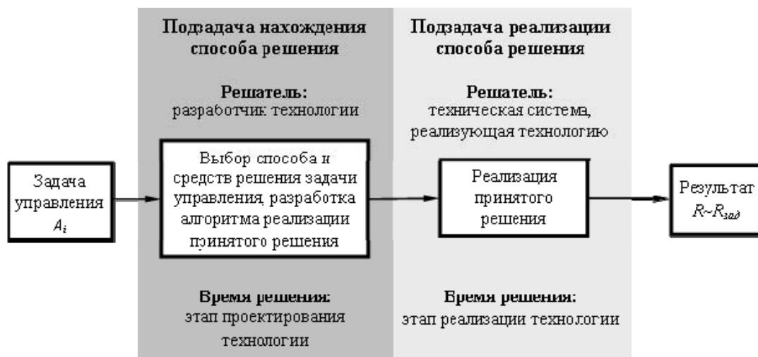
Рис. 3. Процедура решения задачи управления казуальной (детерминированной) системой
