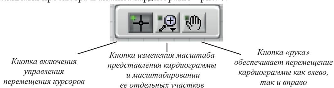
Рис. 7. Панель управления режимами
